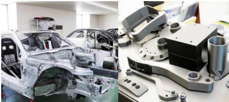
市販車を競技車両に改造するには大幅な軽量化と強化が必要なため、金属製の部品を積極的に樹脂化。X7は高精度な造形が可能で、製作効率とコスト削減効果も高い。
